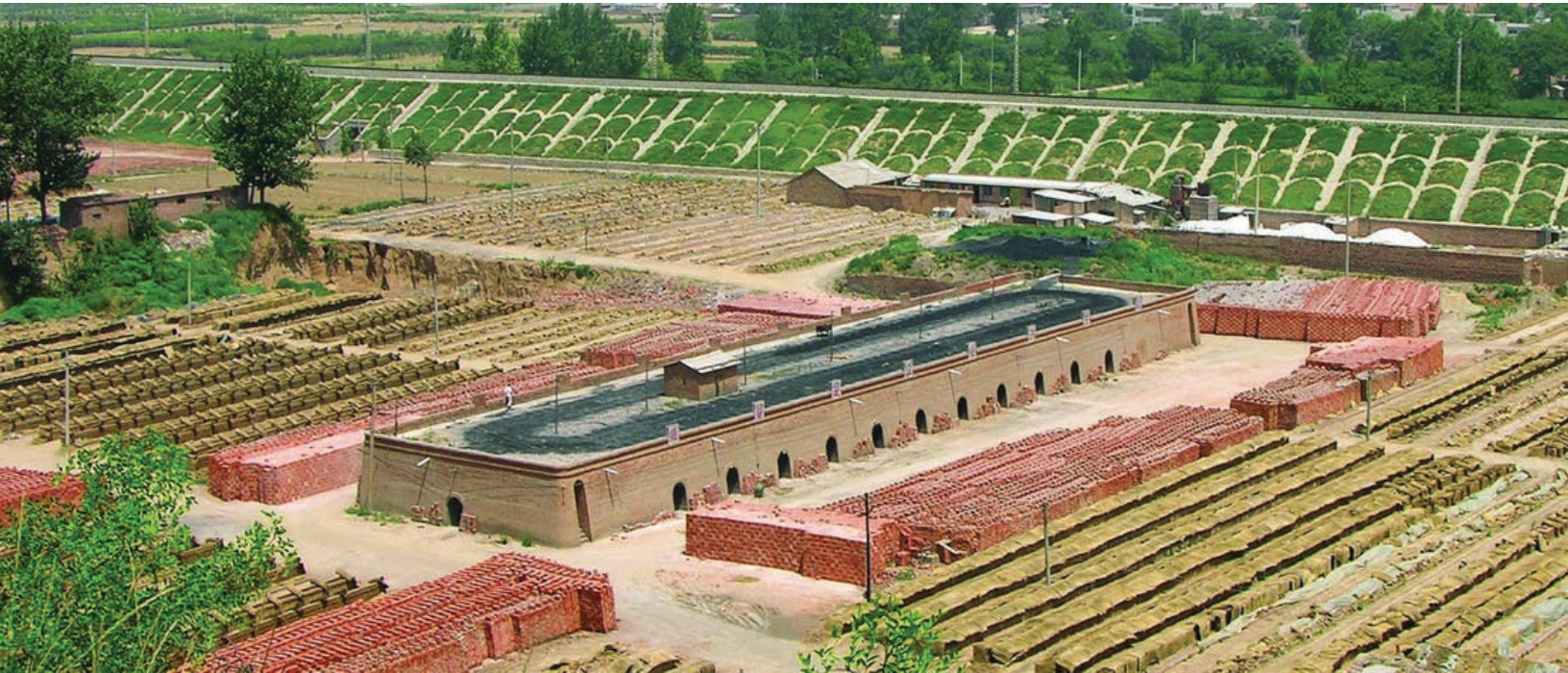
中国：刘村空心砖厂。GEF 帮助建设了这个高效三拱砖窑，并协助将此技术推广至孟加拉国
